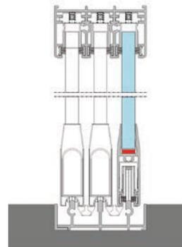
S20 flach, 3-schienig, bodenbündig
